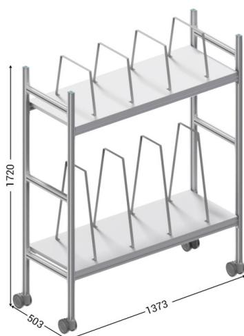
Le **chariot mobile porte-cartons** |PACKINGPOST 500 est indispensable pour faciliter le transport des cartons à proximité immédiate de la ligne de production.
